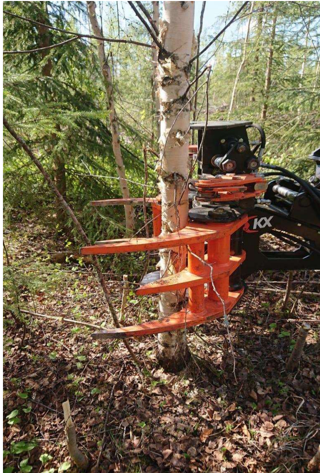
ZDJĘCIE 1. Drzewo jest pomiędzy ostrzem i szczypcami pod kątem 90 stopni.
